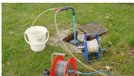
Beprobung einer Grundwassermessstelle mit MP1
